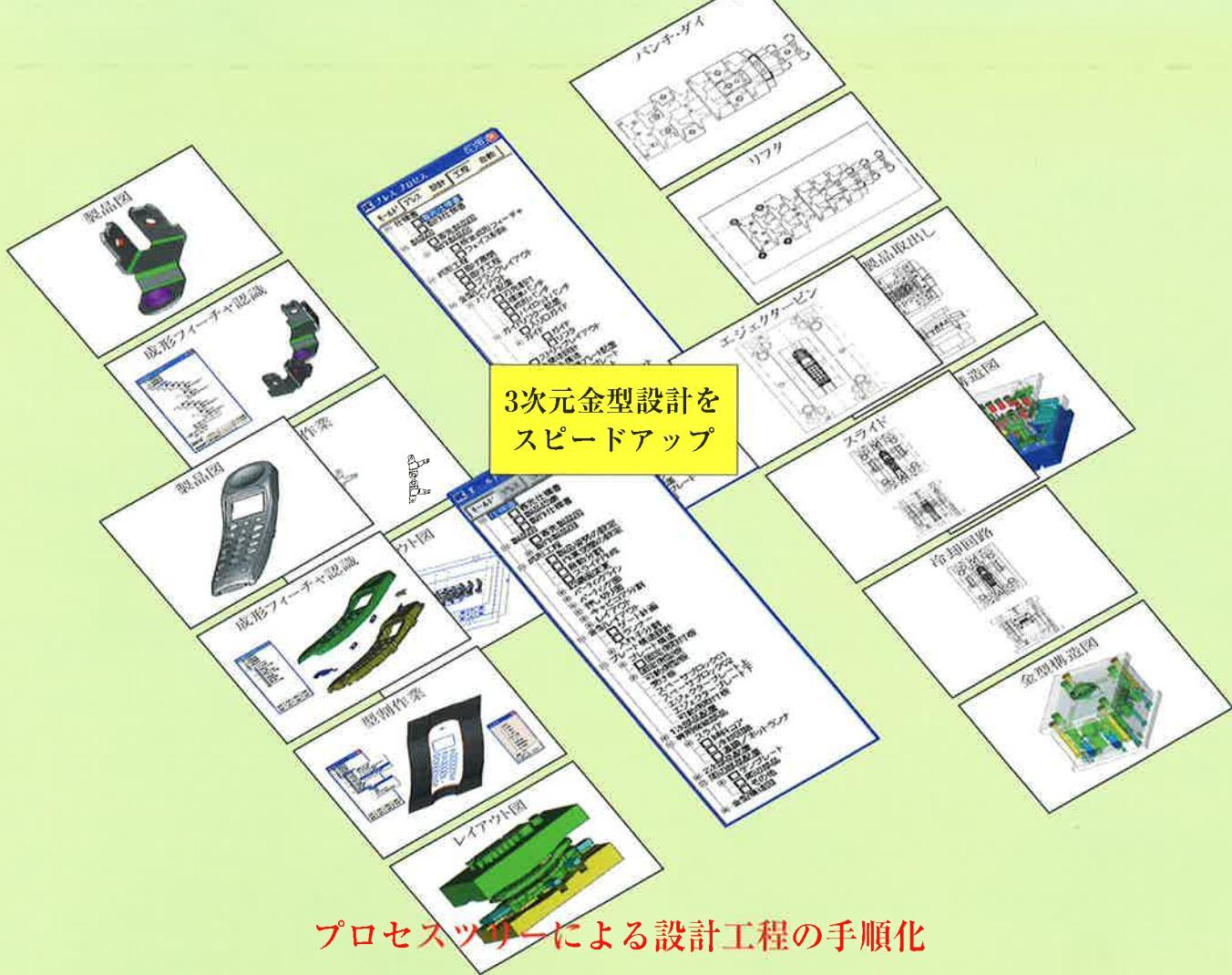
モールド/プレス金型設計用の手順化ツールMOLDauto/PRESSautoは設計工程を手順化したもので、プロセスツリーが設計対象である製品図または製作仕様書の内容に応じて登録されている中から呼び出され、必要に応じて作業中でも項目の追加、削除ができます。プロセスツリーによる設計作業は選択などの補助は必要だが半自動的に進められるもので、変更箇所は前に戻って再実行を行います。製品図、型割/展開作業、レイアウトとプレート構造の工程では手順通りに作業が進められるため特に有効です。次の工程である詳細設計では計画作業を行う必要がありますが、ほとんどのジオメトリデータはプロセスツリーにより前工程より引出せます。最後の工程である製作図面の出力も管理されています。
