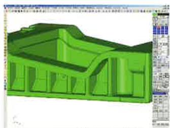
**成形工程図と3次元工具設計**
